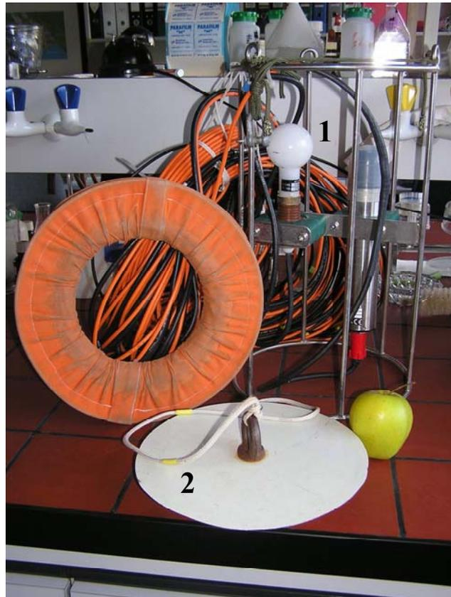
Abb. 16: Geräte zum Messen der Lichtintensität (LI-CHOR Kugelsensor, 1) und der Sichttiefe (Secchi-Scheibe, 2).
